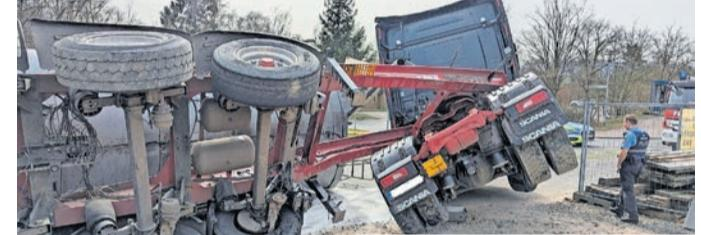
Auf einem unbefestigten Gelände hatte eine Baufirma einen Zwischenlagerplatz für Material eingerichtet. Ein LKW wollte dort Split abladen, doch bei dem Kippvorgang brach der Hydraulikstempel, der die Mulde hochdrückt, zusammen. Der LKW kippte um und die gesamte Ladung lag auf der Straße und blockierte diese. Hydrauliköl lief aus dem defekten Stempel aus.
